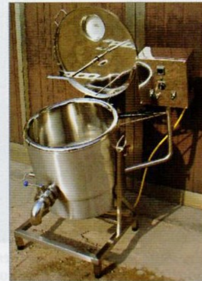
Fig. 8.25 – Soluzione minimale per minicaseificio ad alimentazione elettrica: a sinistra una caldaietta da 70 litri.
