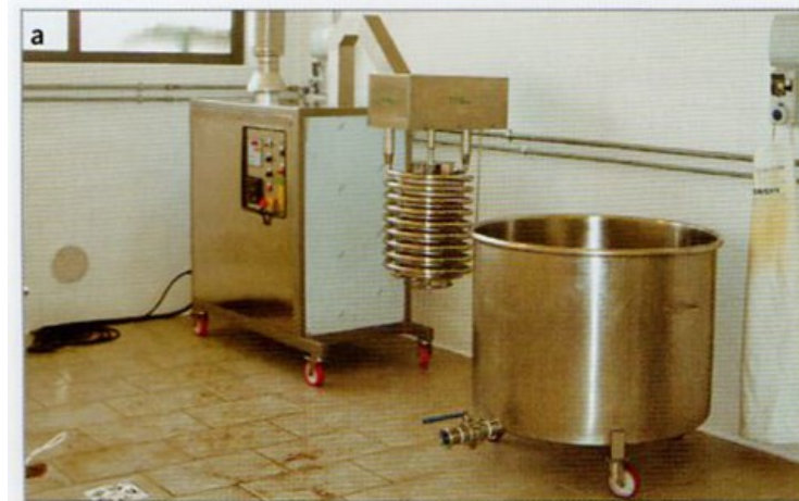
Fig. 8.21 – Un modernissimo impianto per minicaseificio di nuova concezione due caldaiette camiciate di tipo diverso, adatte a produzioni diversificate, accoppiate con un potente gruppo energetico e dotate di comandi programmabili computerizzati.
