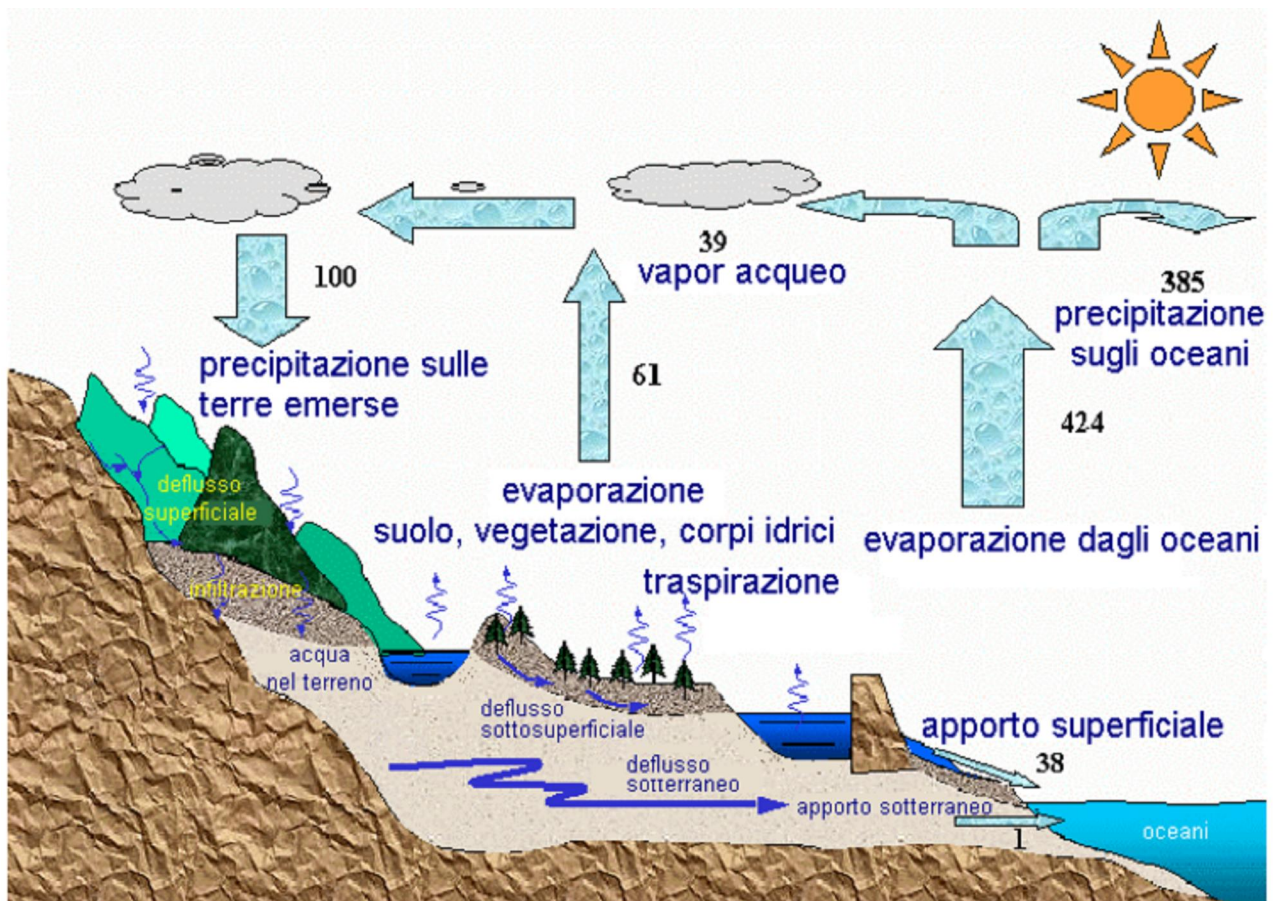
Figura 1 - Flussi all'interno del ciclo idrologico. Le unità sono in termini relativi alla precipitazione annuale sulla superficie terrestre (100 = 119.000 km 3 anno -1 )
