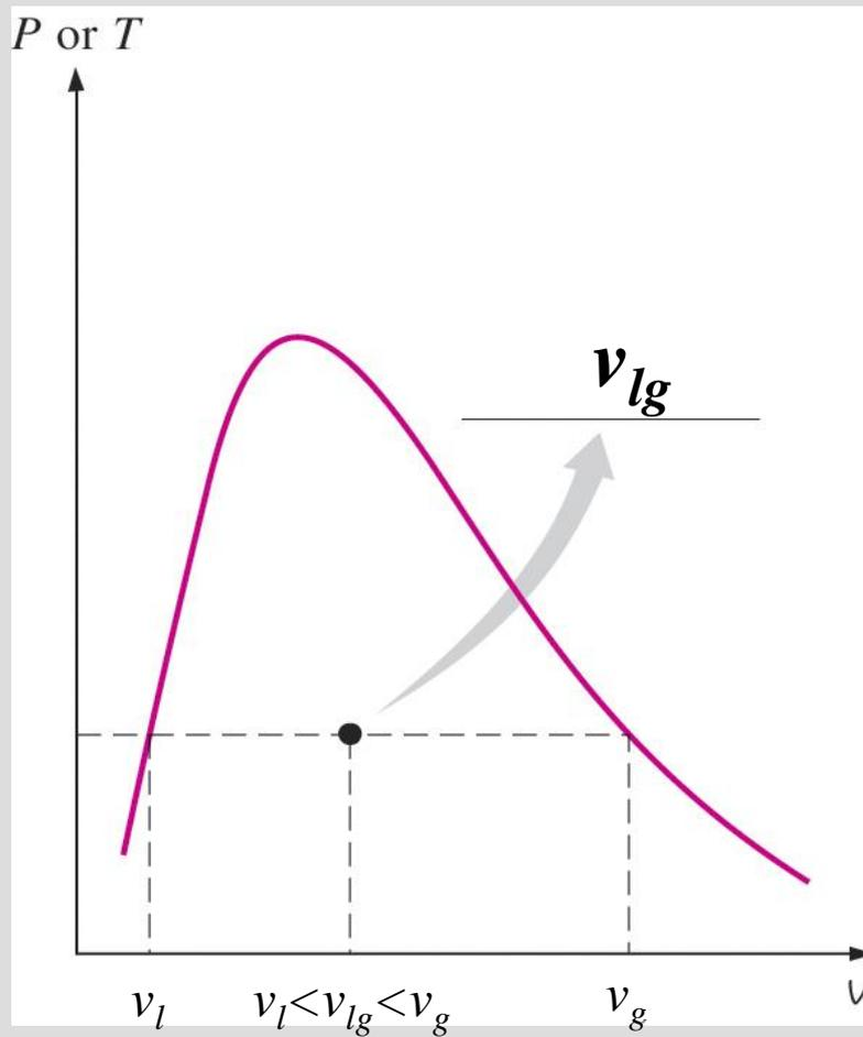
Il valore  $v_{l,g}$  di una miscela satura sta tra  $v_l$  and  $v_g$  a date  $p$  e  $T$
