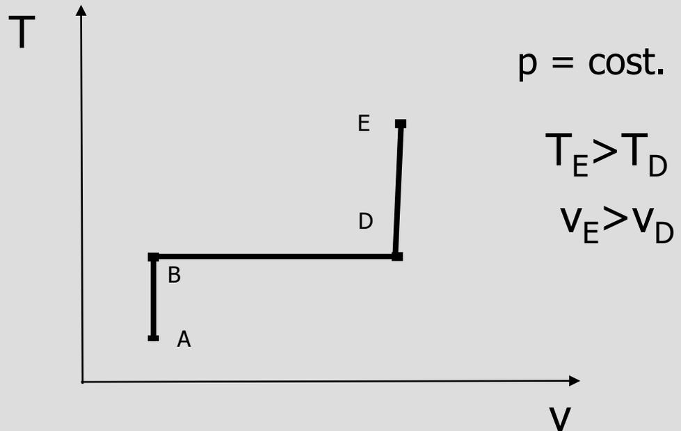
Raggiunto lo stato E la sostanza in fase liquida comincia ad **evaporare**.
