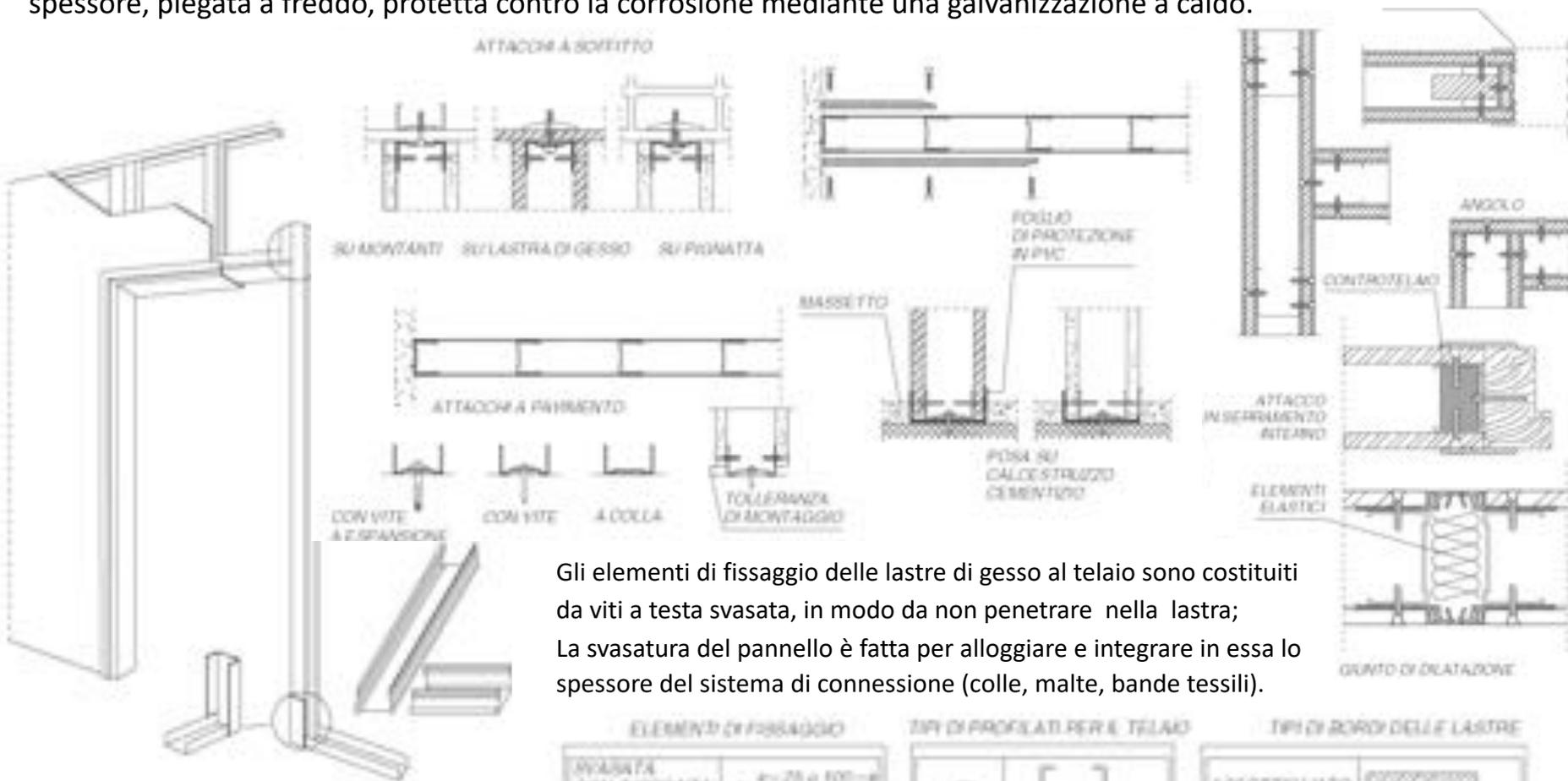
Gli elementi di fissaggio delle lastre di gesso al telaio sono costituiti da viti a testa svasata, in modo da non penetrare nella lastra; La svasatura del pannello è fatta per alloggiare e integrare in essa lo spessore del sistema di connessione (colle, malte, bande tessili).
