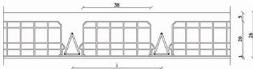
I travetti prefabbricati fanno da appoggio alle pignatte. Il comportamento dell'intonaco all'intradosso cambierà in funzione del materiale di costituzione dei travetti.
