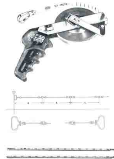
Esempi di longimetri per il rilievo dell'architettura
