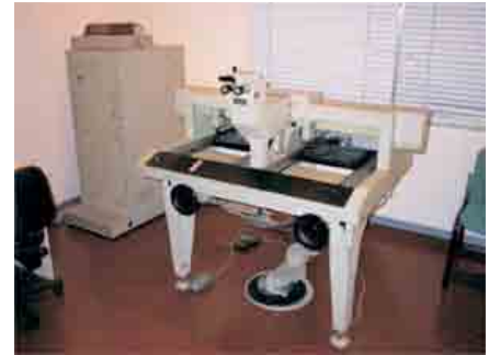
Restitutore analitico “Digicart 40” della Galileo Siscam
