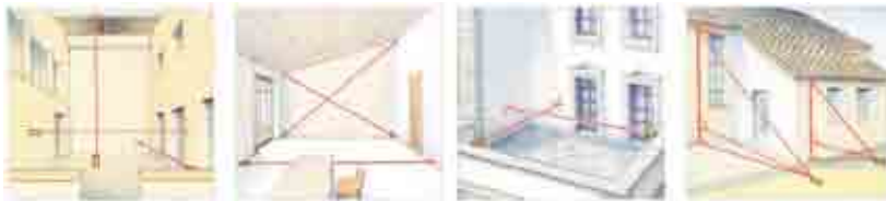
Schemi di rilevamento per mezzo di un distanziometro elettronico
