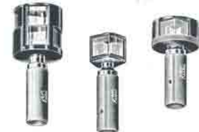
Squadri ottici e schemi di funzionamento
