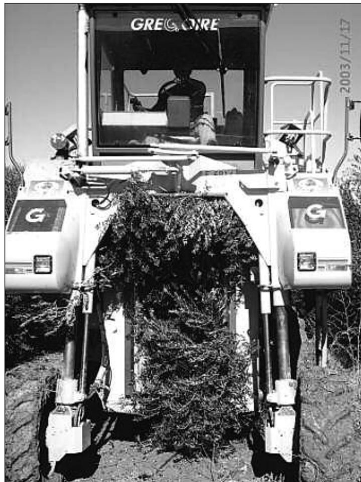
Foto 3 - Scavallatrice in impianto a siepi (superintensivo)
