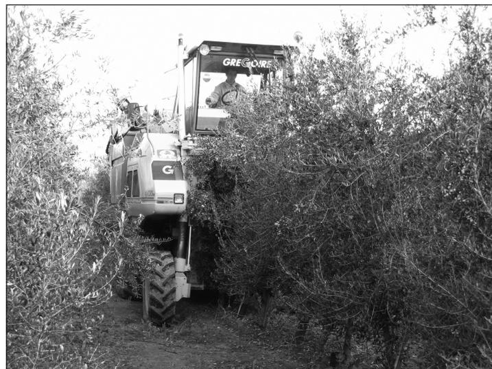
Foto 1 - Macchina scavallatrice in lavorazione
