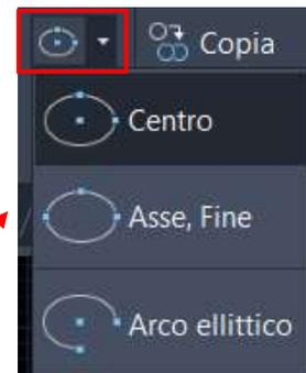
Esistono altre due modalità per disegnare una ellisse. Oltre a “Centro” è possibile disegnare un arco usando altre opzioni, “Asse, Fine” e “Arco ellittico” ossia fornendo altri dati input, comode a seconda delle necessità del disegno. Sulla riga di comando appariranno le indicazioni sui dati da immettere in successione.
