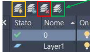
Una volta creato il nuovo layer, gli si attribuisce un nome (significativo di quello che sarà il suo contenuto) e si stabilisce il colore, il tipo di linea e lo spessore, che verrà assegnato automaticamente a tutti gli oggetti in esso contenuti. È utile creare tutti i layer (linee, linee sottili, testi, quote...) nella fase iniziale del disegno. Quindi si chiude la finestra di gestione dei layer con la X in alto a sinistra.
