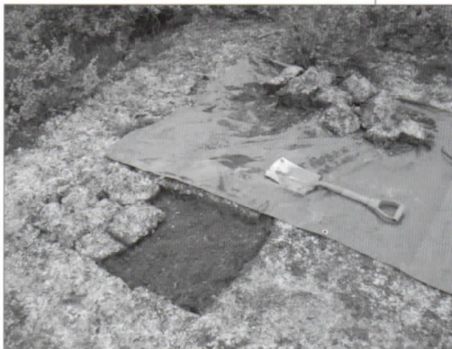
Fig. 3.3 - Una volta terminati la descrizione del profilo del suolo ed il suo eventuale campionamento per le analisi di laboratorio, il materiale estratto durante lo scavo, opportunamente posto su un telo di plastica, viene ricollocato nella trincea, pressato e coperto con le zolle di orizzonte organico conservate a parte.
