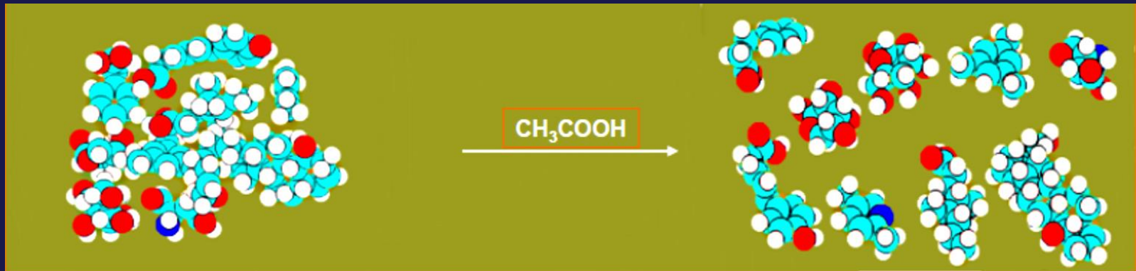
Fig. 8.74 - Risultati sperimentali (HPSEC, NMR, ESI-MS) indicano che le sostanze umiche, piuttosto che essere macromolecole, sono auto-associazione supramolecolari di molecole eterogenee e relativamente piccole unite da legami deboli (van der Waals, \pi - \pi , CH- \pi ) che possono essere distrutti da limitate quantità di acidi organici (MODELHYPERCHEM software) (modificata da Piccolo, 2007)
