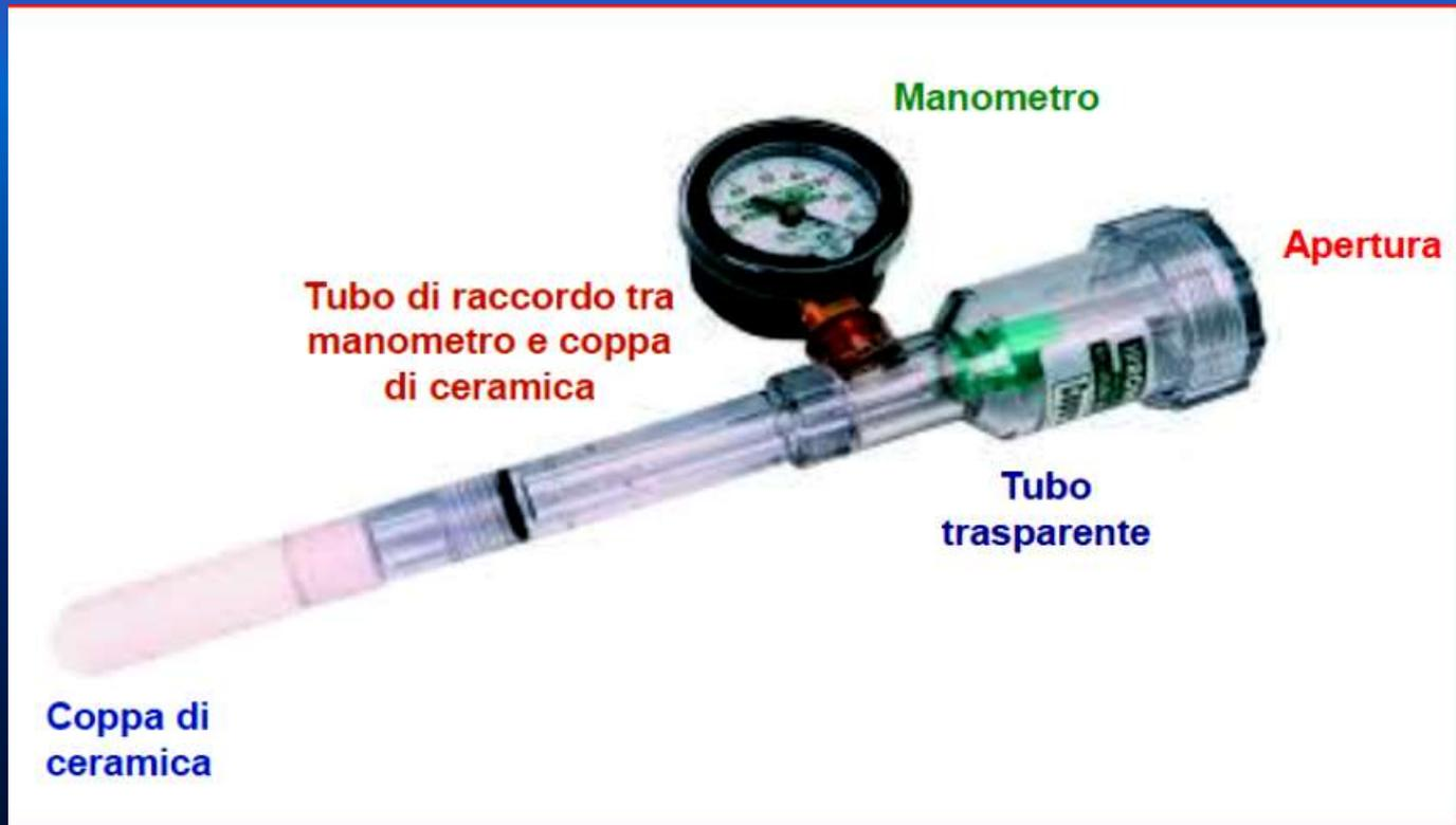
Fig. 10.23 - Tensiometro utilizzato per misurare il potenziale dell'acqua in pieno campo.
