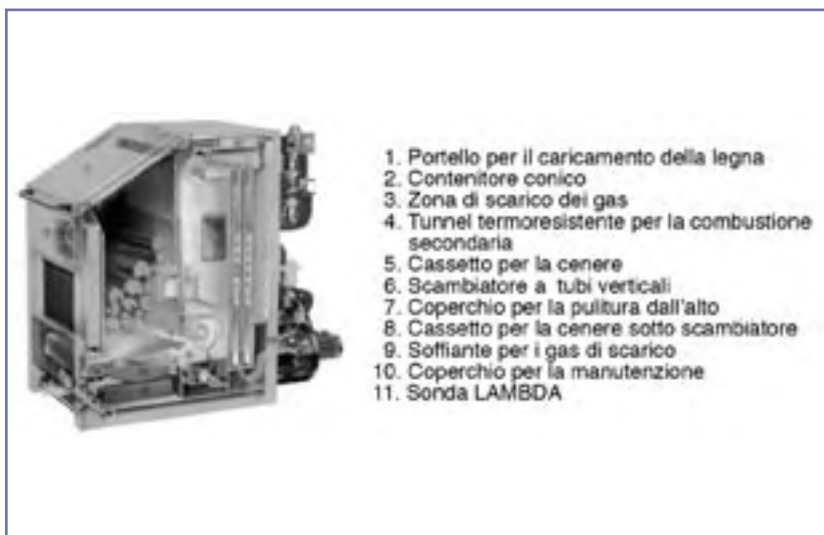
Figura 20 - Caldaia a fiamma inversa per la combustione di legna in ciocchi (fonte AIEL)
