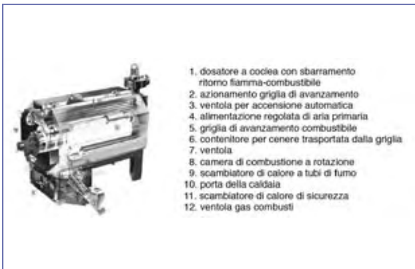
Figura 25 - Caldaia a griglia mobile con movimento rotatorio (fonte: Requisiti tecnici per impianti a cippato superiori a 350 kW, Energia e Ambiente)
