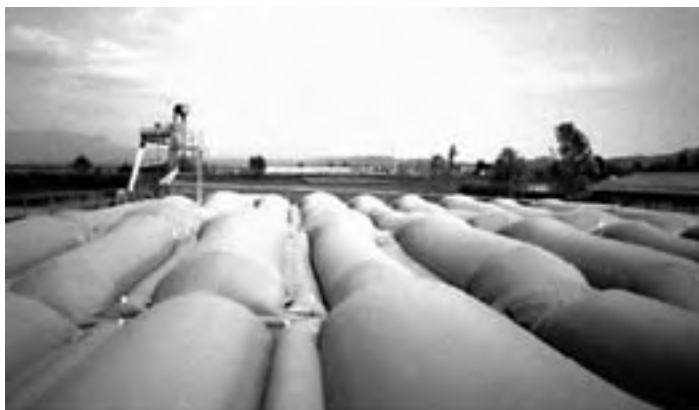
Figura 10 - Copertura gasometrica galleggiante (fonte: CRPA)
